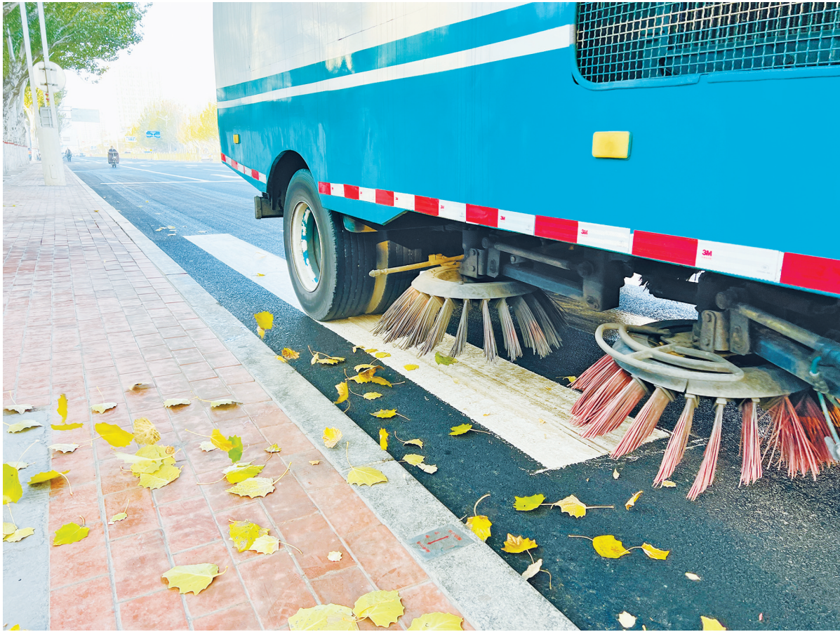
干扫车通过刷子、气流共同完成清扫作业。
