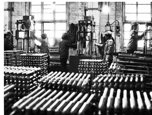
生产摩托车减震器。(资料图)
