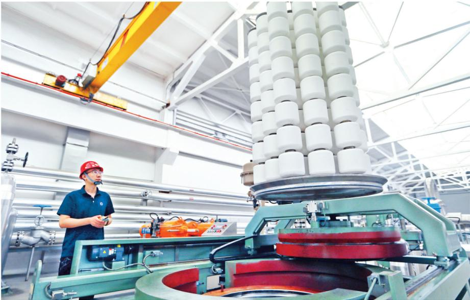
2025年6月20日,在青岛市即墨区即发集团股份有限公司超临界二氧化碳无水染色生产线上,工人将一批待染的聚酯纤维筒子纱装入染缸。
