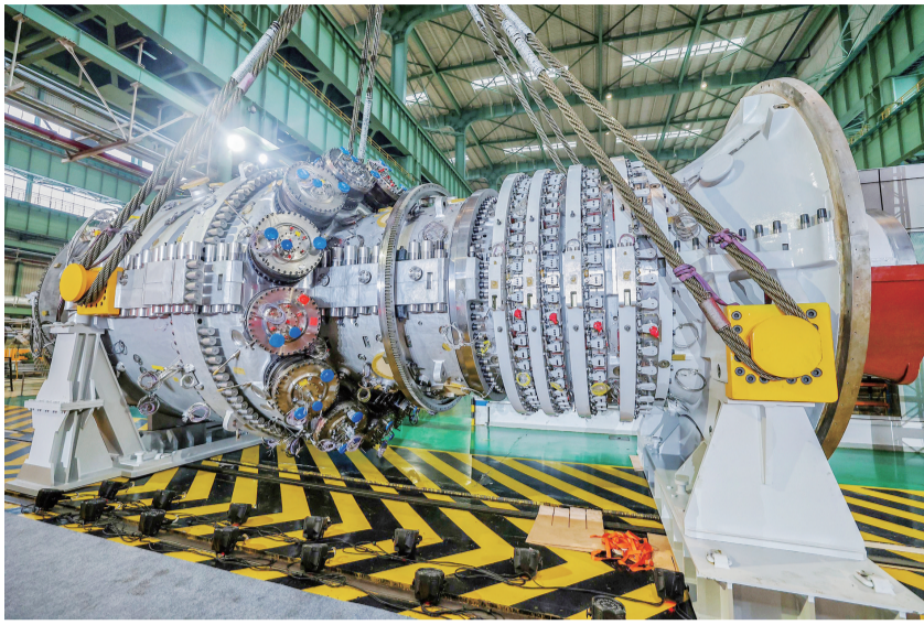
这是300兆瓦级F级重型燃气轮机(资料照片)。
