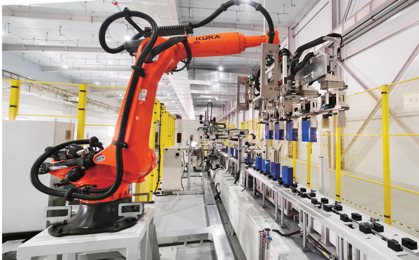
清陶能源科技公司储能电池组PACK与储能系统生产线。
